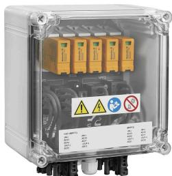
PV Next 発電機端子箱は、1 ~ 12 個の MPP トラッカー搭載インバーター向けに、太陽光発電システムの DC 側を保護するために使用されます。発電機端子箱は過電圧からインバーターを保護するため、欧州指令 CLC/TS 51643-32 に準拠しています。さらに、これらの製品は逆電流からシステムを保護したり、設置中にケーブルを保護するためにストリングスを統合する場合があります。
