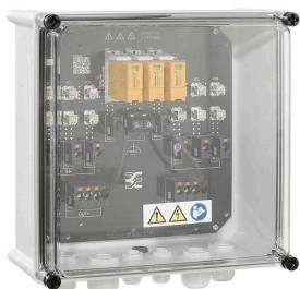
PV Next 発電機端子箱は、1 ~ 12 個の MPP トラッカ一搭載インバーター向けに、太陽光発電システムの DC 側を保護するために使用されます。発電機端子箱は過電圧からインバーターを保護するため、欧州指令 CLC/TS 51643-32 に準拠しています。さらに、これらの製品は逆電流からシステムを保護したり、設置中にケーブルを保護するためにストリングスを統合する場合があります。
