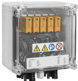
PV Next 発電機端子箱は、1 ~ 12 個の MPP トラッカーダイオードインバーター向けに、太陽光発電システムの DC 側を保護するために使用されます。発電機端子箱は過電圧からインバーターを保護するため、欧州指令 CLC/TS 51643-32 に準拠しています。さらに、これらの製品は逆電流からシステムを保護したり、設置中にケーブルを保護するためにストリングスを統合する場合があります。
