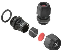
Ex e (安全増防爆) や Ex i (本質安全防爆) の爆発危険場所での使用に適したポリアミド性電線貫通物。ワイドミュラーは、制限なしで製品シリーズを提供し、規格への適合に加えて、4/7 Joule の耐衝撃性の向上、および制限なしでの - 60 °Cまでの許容温度範囲により、電線貫通金物は優れた性能を有します。それらは、電流標準および EN 60079-0 指令に準拠してテストされ、ATEX および IECEx 認証を取得しています。
