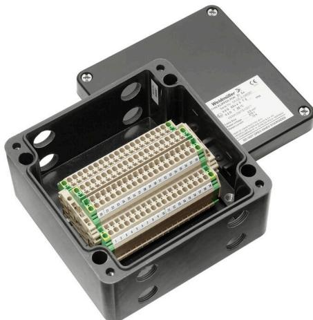
爆発危険区域に信号 / 電源または分電器を設置する際に、さまざまな種別の端子ボックスを使用できます。端子ボックスは、ゾーン 0、1、2、20、21、22 の防爆区域での使用が承認された爆発保護機器です。それは、最新の国際規格 Ex e、Ex ia、Ex tb に準拠した認可を取得しています。お客様固有の設定では、これらの端子ボックスがすべてのアプリケーションに最適なソリューションとなります。製品の概要を参照して、お客様に最適なソリューションを見つけてください。スレッド穿孔の有無に関係なく、最適な取り付けレールまたは適合済のストリップ端子をエンクロージャーに組み合わせます。お客様に合わせて少し選択を行いましたが、お客様に最適な調整ソリューションを構成できます。
