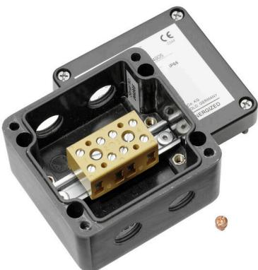
爆発危険区域に信号 / 電源または分電器を設置する際に、さまざまな種別の端子ボックスを使用できます。端子ボックスは、ゾーン 0、1、2、20、21、22 の防爆区域での使用が承認された爆発保護機器です。それは、最新の国際規格 Ex e、Ex ia、Ex tb に準拠した認可を取得しています。お客様固有の設定では、これらの端子ボックスがすべてのアプリケーションに最適なソリューションとなります。製品の概要を参照して、お客様に最適なソリューションを見つけてください。スレッド穿孔の有無に関係なく、最適な取り付けレールまたは適合済のストリップ端子をエンクロージャーに組み合わせます。お客様に合わせて少し選択を行いましたが、お客様に最適な調整ソリューションを構成できます。
