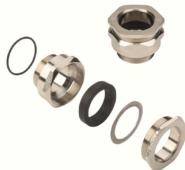
KSG は、非外装ケーブルと配線を接続する場合にのみ使用します。ケーブルグランドをネオプレンシールと共に注文すると、シールは温度を-35Cから+90Cまで許容する。シリコーンシールを使用する場合は、-60C ~ +180C の温度範囲が可能である。伝達部に含まれる O リングとケーブルグランドは、同じ材質で作られています。このシール材を使用する場合、水深 25 メートル (2.5 bar の圧力) での IP66 または IP68 の保護が保証されます。KSG は、高耐圧性の耐圧防爆 (Ex d) 封入および安全増防爆 (Ex e) での使用が許可されています。
