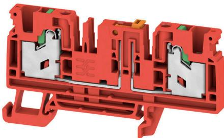
一部の用途では、テストや安全の目的で、テストポートまたは断路要素をフィードスルー端子に追加することが妥当です。テスト断路端子を使用すれば、無電圧状態で電流回路を測定できます。断路中、空気パスおよびクリープパスの寸法は評価されませんが、指定の定格突入電圧の強度を確認する必要があります。
