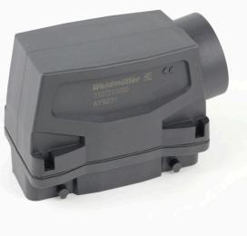
プラスチックエンクロージャーは、金属の抵抗が不十分な用途に特に最適です。さらに、このスライドに示すエンクロージャーは、標準のアルミ製のエンクロージャよりも軽量で、わずかに安価です。そのため、素材の強度がそれほど必要ない用途では、プラスチック製エンクロージャを使用することが賢い選択であると言えます。密閉性は変わらず IP65 を保持しています。
