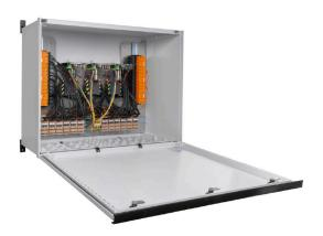
安全なリモートシャットダウン用 屋上の太陽光発電システムは、ケーブルが建物内に引き込まれた後の建物内の電力網との接続点で遮断装置が必要になることがあります。これにより、消防団は、不必要な危険を冒すことなく、緊急時の活動を行うことができます。電源が復旧すると、PV Next Fireman Switch が自動的にPVストリングを再接続します。
