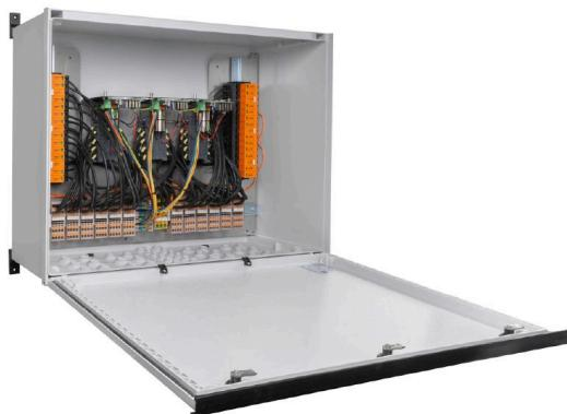
安全なリモートシャットダウン用 屋上の太陽光発電システムは、ケーブルが建物内に引き込まれた後の建物内の電力網との接続点で遮断装置が必要になることがあります。これにより、消防団は、不必要的危険を冒すことなく、緊急時の活動を行うことができます。電源が復旧すると、PV Next Fireman Switch が自動的にPVストリングを再接続します。
