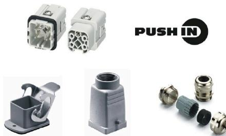
HDC (ヘビーデューティーコネクタ) キットは、完全なプラグインコネクタを組み立てるための標準キットです。HDC キットは通常、オス型インサート、メス側インサート、プラグハウジング、隔壁ハウジング、およびケーブルランドから構成されます。ワイドミュラーは、測定基準または PG ケーブル入力スレッドを備えた標準コネクタの組み合わせを提供します。プッシュイン接続は、直接接続の直接插入方式です。組立済導体は、ツールを必要とせずに、導体接続に直接插入できます。
