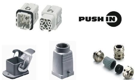
HDC(ヘビーデュティーコネクタ)キットは、完全なプラグインコネクタを組み立てるための標準キットです。HDC キットは通常、オス型インサート、メス側インサート、プラグハウジング、隔壁ハウジング、およびケーブルランドから構成されます。ワイドミュラーは、測定基準または PG ケーブル入力スレッドを備えた標準コネクタの組み合わせを提供します。プッシュイン接続は、直接接続の直接插入方式です。組立済導体は、ツールを必要とせずに、導体接続に直接挿入できます。
