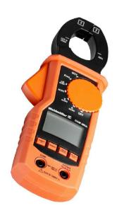
マルチメータは、多数の変数を測定できます。各装置 は電圧および抵抗を測定し、標準として導通およびダイ オードテストを行うことができます。
