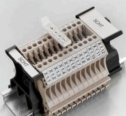
CHT 5 S グループタグキャリアは、TS 32 取り付けレール (G レール) または TS 35 取付レール (トップハットレール) に直接クリップ固定されています。したがって、端子とその種別に関係なく、端子ストリップにラベリングを実施できます。
