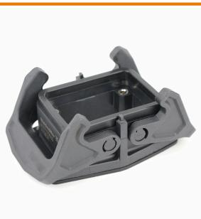
プラスチックエンクロージャーは、金属の抵抗が不十分な用途に特に最適的です。さらに、このスライドに示すエンクロージャーは、標準のアルミ製のエンクロージャよりも軽量で、わずかに安価です。そのため、素材の強度がそれほど必要ない用途では、プラスチック製エンクロージャを使用することが賢い選択であると言えます。密閉性は変わらず IP65 を保持しています。
