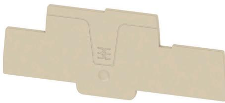
分離プレートとエンドプレートは端子台にとって不可欠なアクセサリです。分離プレートは、異なる電位や機能グループを光学的および電気的に分離し、安全性を高め、制御盤内部の構造を明確にします。エンドプレートは端子台列の側面を閉じ、通電部分との接触を防ぎ、清潔で安定した仕上がりを確保します。どちらのコンポーネントも、それぞれのWeidmüller端子台シリーズに正確に適合しており、安全でコンプライアンスに準拠したプロフェッショナルな配線に役立ちます。
