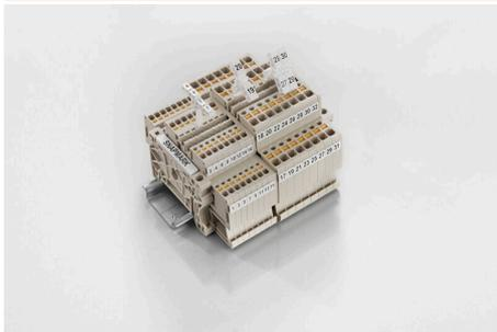
SnapMark - このタグキャリアは、I モデルシリーズの二段端子 IDK 1.5N に対応して特別に開発されています。柔軟なピボット機構は、渡り配線の容易な取り付け、取り外しを可能にします。4 種の DEK 5 ラベリングタグ、または 2 種の WS 10/5 Middle コネクタマーカーを保持できます。
