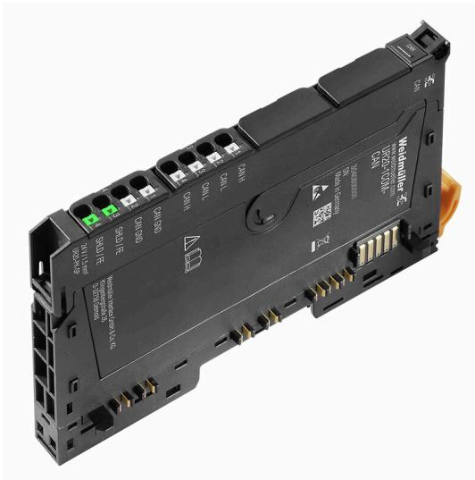
デジタルカウンターと通信モジュール 100/500 kHz、32 ビットのカウンター分解能；個別チャネル診断が利用できます現在の自動化システムでは、インクリメンタルおよびアブソリュートエンコーダが不可欠です。
