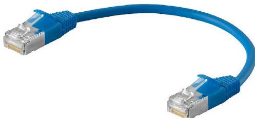
RJ45 をふたつ備えた組立済ケーブルは、スマートメータリングアプリケーションに適合し、DIN VDE 0603-100 準拠の異なるカラーを使用できます。プラグとケーブルの曲げ半径を小さくし、狭いスペースに対応、プラグのハウジングは円周方向に絶縁されており、嵌合状態で保護等級IP30を実現します。
