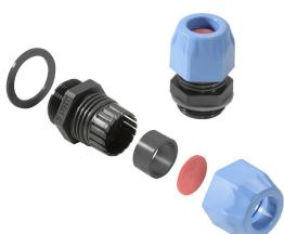
Ex e (安全増防爆) や Ex i (本質安全防爆) の爆発危険場所での使用に適したポリアミド性電線貫通物。Weidmüller は、制限なしで製品シリーズを提供し、規格への適合に加えて、4/7 Joule の耐衝撃性の向上、および制限なしでの -60 °C までの許容温度範囲により、電線貫通金物は優れた性能を有します。それらは、電流標準および EN 60079-0 指令に準拠してテストされ、ATEX および IECEx 認証を取得しています。
