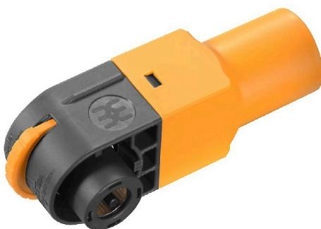
再生可能エネルギーの分野では、バッテリーストレージシステムの重要性が高まっています。これらは通常、迅速かつ簡単に交換する必要があるいくつかの個別のバッテリーで構成されています。ワイドミュラーバッテリーコネクタ (WBC) は、複数の個別バッテリーを数少ない簡単な手順で ESS に接続し、必要に応じた迅速な接続を可能にします。より安全で簡単に取り扱えるように、極にははっきりと印が付けられています。正極はオレンジ色、負極は黒となっています。
