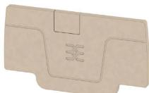
分離プレートとエンドプレートは端子台にとって不可欠なアクセサリです。分離プレートは、異なる電位や機能グループを光学的および電気的に分離し、安全性を高め、制御盤内部の構造を明確にします。エンドプレートは端子台列の側面を閉じ、通電部分との接触を防ぎ、清潔で安定した仕上がりを確保します。どちらのコンポーネントも、それぞれのWeidmüller端子台モデルシリーズに正確に適合しており、安全でコンプライアンスに準拠したプロフェッショナルな配線に役立ちます。
