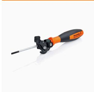
複合型切削 / 被覆剥き工具 Swifty® CS および Swifty® CS セットは、1.5 mm<sup>2</sup> までの単線と 2.5 mm<sup>2</sup> までの可撓導体ケーブルの銅線を圧着不要で切断と被覆を行います。
