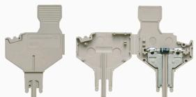
コンポーネントプラグは、電子コンポーネントを接続断路端子台に統合するために使用されます。電子コンポーネントのはんだ付け後、プラグを接続断路端子台の断路箇所に組み込むことで、断路端子台を電子コンポーネント内蔵型のモジューラー端子台に変更します。
