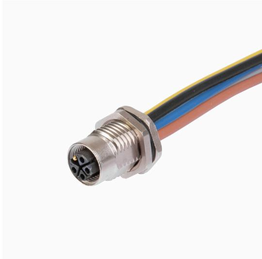
周辺デバイスには、より大きな電力を供給する必要があります。新型 M12 プラグインコネクタを使用すれば、250 V および 2 A 以上を問題なく取り扱えます。小型の A、K、L、S および T コードの M12 プラグインコネクタは、最大 630 V AC または 60 V DC および 12 A の伝送に設計されています。
