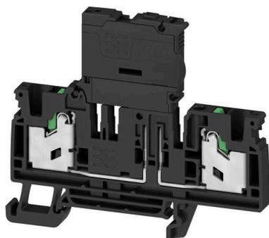
ヒューズ端子台およびコンポーネント端子台により、保護素子や機能素子を端子ストリップへ直接組み込むことができます。ヒューズ端子台には、電気回路を過負荷から確実に保護するための内蔵ヒューズホルダーが含まれており、制御および分電器バーシステムに最適です。コンポーネント端子台を使用すると、ダイオード、抵抗、LEDなどの電子コンポーネントを配線に直接組み込むことができます。これにより、スイッチング機能を省スペースかつ明確に配置した実装と、信号の分離が可能になります。両種の端子台により、安全性の高い、容易なメンテナンス、コンパクトで機能指向の設置が実現します。
