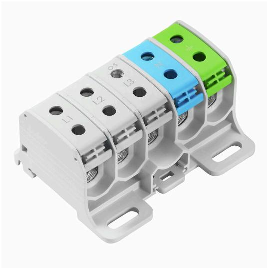
Klippon® Connect 電源供給部端子台 WPD により、アルミニウム製および銅製導体を設置面積の小さい場所に簡単かつ安全に設置できます。電源 電圧供給またはモニター接続もオプションとして使用できます。導体素材に関係なく、お客様は電源供給部端子台 WPD をご使用いただけます。直接または DINレールTS35 に取り付けられます。
