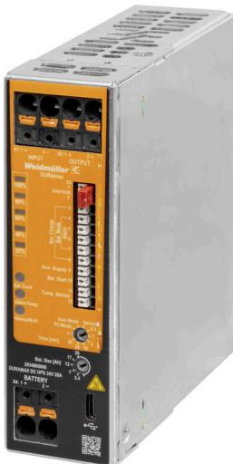
UPS 制御ユニットは、関連バッテリーモジュールおよび電源ユニットと共に完全な DC UPS システムを形成します。通常動作時は、UPS 制御ユニットからの入力電圧は負荷に直接接続されます。主電源障害 (DC 入力電圧低下) が発生した場合、システムは直ちにバッテリー駆動に切り替わります。主電源が復旧するとシステムは通常動作に戻り、内蔵充電器でバッテリーが完全に再充電されます。
