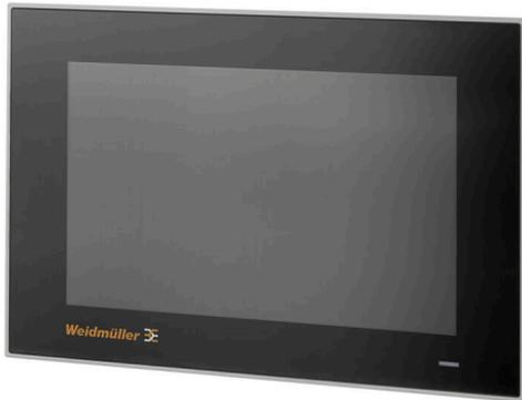
ワイドミュラーの u-view Advanced タッチパネルは、優れた画質で、ほとんどの工業環境で使用することができます。このシリーズはスワイプジェスチャーやグローブ操作に対応した高解像度の静電容量式の 7 インチから 21.5 インチまでのタッチスクリーンを取り揃えています。すべてのパネルは、HTML5 対応のブラウザを使用した Linux オペレーティングシステムを備え、統合キオスクモードとシンプルな構成により、ウェブアプリケーション向けに最適化されています。その結果、ウェブベースの視覚化に最適なソリューションとなり、さまざまなウェブサーバーへのアクセスが可能になります。たとえば、u-OS、u-create PROCON-WEB、u-control web が挙げられます。パネルは特に平らな形状で、工業用等級の IP66 ハウジングを採用しています。
