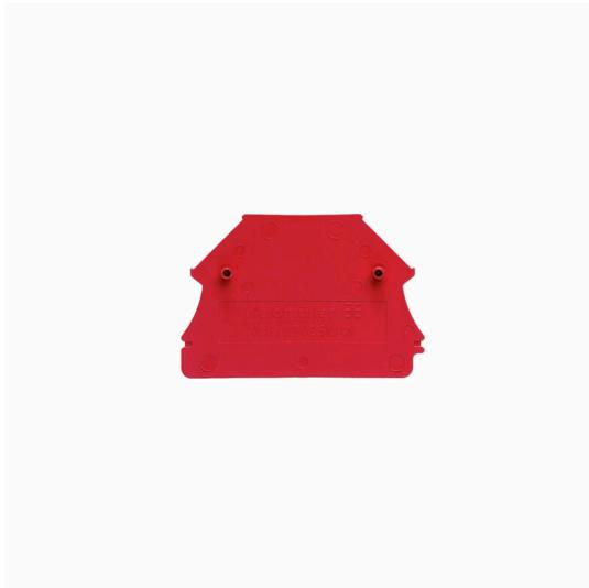
分離プレートとエンドプレートは端子台にとって不可欠なアクセサリです。分離プレートは、異なる電位や機能グループを光学的および電気的に分離し、安全性を高め、制御盤内部の構造を明確にします。エンドプレートは端子台列の側面を閉じ、通電部分との接触を防ぎ、清潔で安定した仕上がりを確保します。どちらのコンポーネントも、それぞれのWeidmüller端子台シリーズに正確に適合しており、安全でコンプライアンスに準拠したプロフェッショナルな配線に役立ちます。
