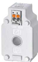
CMA-CTM 7 シリーズ小型電流トランスフォーマーは、円形の一次導体の変流器原理に従って設計された誘導電流トランスフォーマーです。変流器CMA-CTM 7 シリーズはメンテナンスフリーで、32 A ~ 64 A の範囲の一次電流を測定するように設計されています。これは二次側で、最大 1 A の電流に変換されます。小型設計によって、相間距離 17.5mm を有する三相サーキットブレーカのアプリケーションに最適です。
