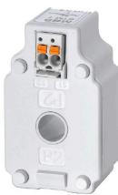
CMA-CTM 7 シリーズ小型電流トランスフォーマーは、円形の一次導体の変流器原理に従って設計された誘導電流トランスフォーマーです。変流器CMA-CTM 7 シリーズはメンテナンスフリーで、32 A ~ 64 A の範囲の一次電流を測定するように設計されています。これは二次側で、最大 1 A の電流に変換されます。小型設計によって、相間距離 17.5mm を有する三相サーチケットブレーカのアプリケーションに最適です。
