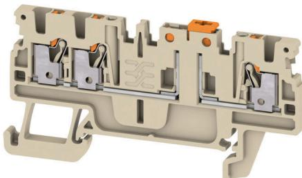
一部の用途では、テストや安全の目的で、テストポイントまたは断路要素をフィードスルー端子に追加することが妥当です。テスト断路端子を使用すれば、無電圧状態で電流回路を測定できます。断路中、空気パスおよびクリープパスの寸法は評価されませんが、指定の定格突入電圧の強度を確認する必要があります。
