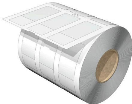
リール取付型 THM WriteOn ケーブルマーカーは、外径 36mm までの導体とケーブルのラベリングに使用します。透明接着ストリップは、マーカー表面の印刷を固定して保護します。
