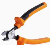
最大外径 8 mm、12 mm、14 mm、22 mm の導体対応カットツール。特殊形状の刃を使用すると、銅およびアルミニウム製の導体を、最小限の物理的な労力とピンチ不使用で切断できます。また切断工具(KT 8 ~ KT 22)には、EN/IEC 60900 に準拠した最大 1,000 V までの VDE および GS でテスト済みの保護絶縁材も付属します。
