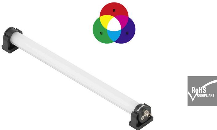
Eシリーズは、スタンダードおよびプレミアムライトを備え、作業領域での集中的な照明に最適です。回転式の取り付けブラケットは、照明範囲の位置決めに必要な柔軟性を提供します。内蔵のM8コネクタにより、簡単かつ迅速な接続が可能で、複数の照明を接続できます。堅固なPMMA製カバーは、必要な保護（IP54）を提供するだけでなく、5.700 Kで均一な照明を確保します。
