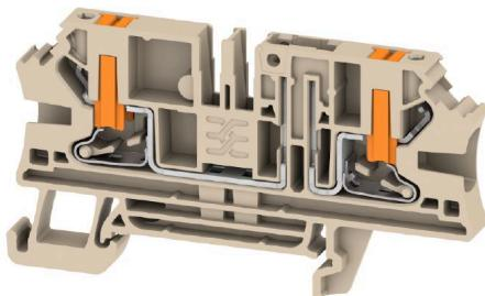
一部の用途では、テストや安全の目的で、テストポイントまたは断路要素をフィードスルー端子に追加することが妥当です。テスト断路端子を使用すれば、無電圧状態で電流回路を測定できます。断路中、空気パスおよびクリープパスの寸法は評価されませんが、指定の定格突入電圧の強度を確認する必要があります。
