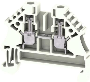
電力、信号、データのフィードスルー転送は、電気工学や制御盤構築における一般的な要件です。絶縁材、接続システム、および端子台の形状が、差別化を左右する機能です。フィードスルー端子台は、1つまたは複数の導体を結合および / または接続するのに適しています。ひとつ以上の接続レベルが、同じ電位上にあるか、もしくは互いに絶縁されている可能性があります。
