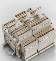
SnapMark - このタグキャリアは、I モデルシリーズの二段端子 IDK 1.5N に対応して特別に開発されています。柔軟なピボット機構は、渡り配線の容易な取り付け、取り外しを可能にします。4 種の DEK 5 ラベリングタグ、または 2 種の WS 10/5 Middle コネクタマーカーを保持できます。
