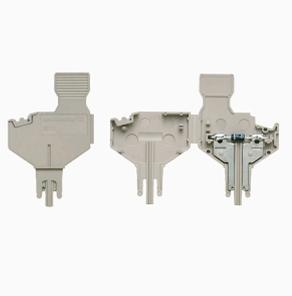
コンポーネントプラグは、電子コンポーネントを接続断端端子台に統合するために使用されます。電子コンポーネントのはんだ付け後、プラグを接続断端端子台の断端箇所を組み込むことで、断端端子台を電子コンポーネント内蔵型のモジュラー端子台に変更します。
