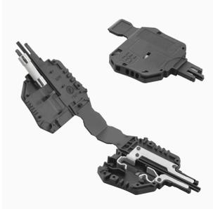
ヒューズホルダー SIHAは、断路端子をヒューズ端子に素早く切り替えます。断路レバーをそのまま取り外してヒューズユニットを取り付けます。
