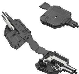
ヒューズホルダー SIHAは、断路端子をヒューズ端子に素早く切り替えます。断路レバーをそのまま取り外してヒューズユニットを取り付けます。
