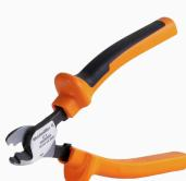
最大外径 8 mm、12 mm、14 mm、22 mm の導体対応カットツール。特殊形状の刃を使用すると、銅およびアルミニウム製の導体を、最小限の物理的な労力とピンチ不使用で切断できます。また切断工具(KT 8 ~ KT 22)には、EN/IEC 60900 に準拠した最大 1,000 V までの VDE および GS でテスト済みの保護絶縁材も付属します。
