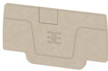
分離プレートとエンドプレートは端子台にとって不可欠なアクセサリです。分離プレートは、異なる電位や機能グループを光学のおよび電気的に分離し、安全性を高め、制御盤内部の構造を明確にします。エンドプレートは端子台列の側面を閉じ、通電部分との接触を防ぎ、清潔で安定した仕上がりを確保します。どちらのコンポーネントも、それぞれのWeidmüller端子台シリーズに正確に適合しており、安全でコンプライアンスに準拠したプロフェッショナルな配線に役立ちます。
