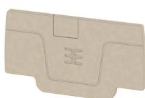
分離プレートとエンドプレートは端子台にとって不可欠なアクセサリです。分離プレートは、異なる電位や機能グループを光学的および電気的に分離し、安全性を高め、制御盤内部の構造を明確にします。エンドプレートは端子台列の側面を閉じ、通電部分との接触を防ぎ、清潔で安定した仕上がりを確保します。どちらのコンポーネントも、それぞれのWeidmüller端子台シリーズに正確に適合しており、安全でコンプライアンスに準拠したプロフェッショナルな配線に役立ちます。
