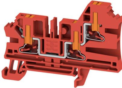
電力、信号、データのフィードスルー転送は、電気工学や制御盤構築における一般的な要件です。絶縁材、接続システム、および端子台の形状が、差別化を左右する機能です。フィードスルー端子台は、1つまたは複数の導体を結合および/または接続するのに適しています。ひとつ以上の接続レベルが、同じ電位上にあるか、もしくは互いに絶縁されている可能性があります。
