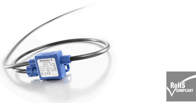
ロゴスキーコイルロゴスキーコイルは、交流およびパルス電流の浮遊電位測定に用いられる強磁性コアを有さない閉鎖状態の空心コイルです。ロゴスキーコイルを用いた測定は、既存のシステムの一次電流回路を絶縁することなく遡及的に集積できるため、技術的に広く利用されています。この方法は飽和効果を示さないので、最小の電流や高周波高調波でも精度を落とさずに測定できます。
