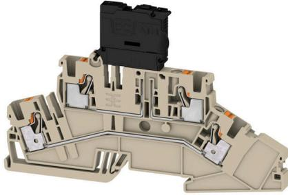
ヒューズ端子台およびコンポーネント端子台により、保護素子や機能素子を端子ストリップへ直接組み込むことができます。ヒューズ端子台には、電気回路を過負荷から確実に保護するための内蔵ヒューズホルダーが含まれており、制御および分電器バーシステムに最適です。コンポーネント端子台を使用すると、ダイオード、抵抗、LEDなどの電子コンポーネントを配線に直接組み込むことができます。これにより、スイッチング機能を省スペースかつ明確に配置した実装と、信号の分離が可能になります。両種の端子台により、安全性の高い、容易なメンテナンス、コンパクトで機能指向の設置が実現します。
