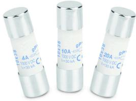
gPV 円筒型ヒューズカートリッジは、最大電圧 1,500 DC までの太陽光発電モジュールの保護 (フィールド保護) を小型かつ安全で経済的に実現するために設計されています。これらは、過負荷と短絡の両方に対する保護を提供します (IEC60269-6 および UL248-19 規格準拠 GPV クラス)。内部圧力と熱衝撃に優れたセラミック製チューブで製造され、狭いスペースでも高いスイッチング容量を発揮します。接点は銀メッキ加工銅と純銀の可溶性元素で構成され、経年劣化を防ぎ、電気的特性を不変に保ちます。それらのサイズは 10 x 38 mm、10 x 85 mm、22 x 58 mm がご利用いただけます。
