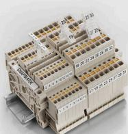
SnapMark - このタグキャリアは、I モデルシリーズの二段端子 IDK 1.5N に対応して特別に開発されています。柔軟なピボット機構は、渡り配線の容易な取り付け、取り外しを可能にします。4 種の DEK 5 ラベリングタグ、または 2 種の WS 10/5 Middle コネクタマーカーを保持できます。
