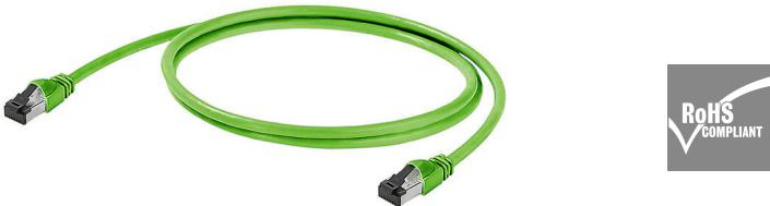
RJ45 をふたつ備えた組立済ケーブルは、スマートメータリングアプリケーションに適合し、DIN VDE 0603-100 準拠の異なるカラーを使用できます。プラグとケーブルの曲げ半径を小さくし、狭いスペースに対応、プラグのハウジングは円周方向に絶縁されており、嵌合状態で保護等級IP30を実現します。
