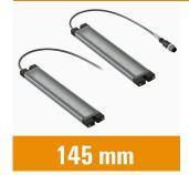
WIL-LED 照明:高さわずか8 mm (マグネット付属は9.4 mm)のDC 24 V 対応のLED 照明で、非常に高い発光効率と長い耐用期間(6万時間以上)を実現しています。完全なポッティングと金属製ハウジングによる非常に堅固な構造-防水仕様(IP67)。6500 K の光色(昼光色)により、様々なアプリケーションに適しています。M12 接続との簡易な接続性を有します。電力消費が少ないため、24 V で動作する小型電源電圧供給で十分です。
