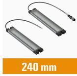
WIL-LED 照明:高さわずか8 mm (マグネット付属は9.4 mm)のDC 24 V 対応のLED 照明で、非常に高い発光効率と長い耐用期間(6万時間以上)を実現しています。完全なポッティングと金属製ハウジングによる非常に堅固な構造-防水仕様(IP67)。6500 K の光色(昼光色)により、様々なアプリケーションに適しています。M12 接続との簡易な接続性を有します。電力消費が少ないため、24 V で動作する小型電源電圧供給で十分です。
